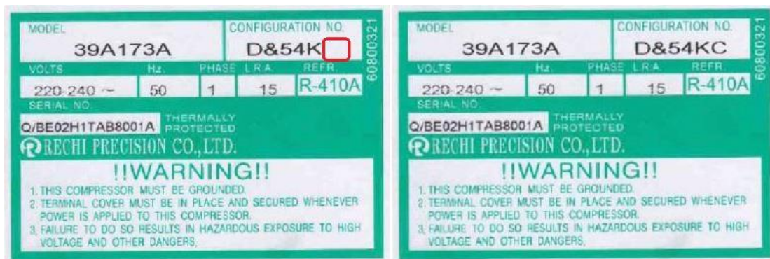
左圖缺少1碼，右圖正確編碼
